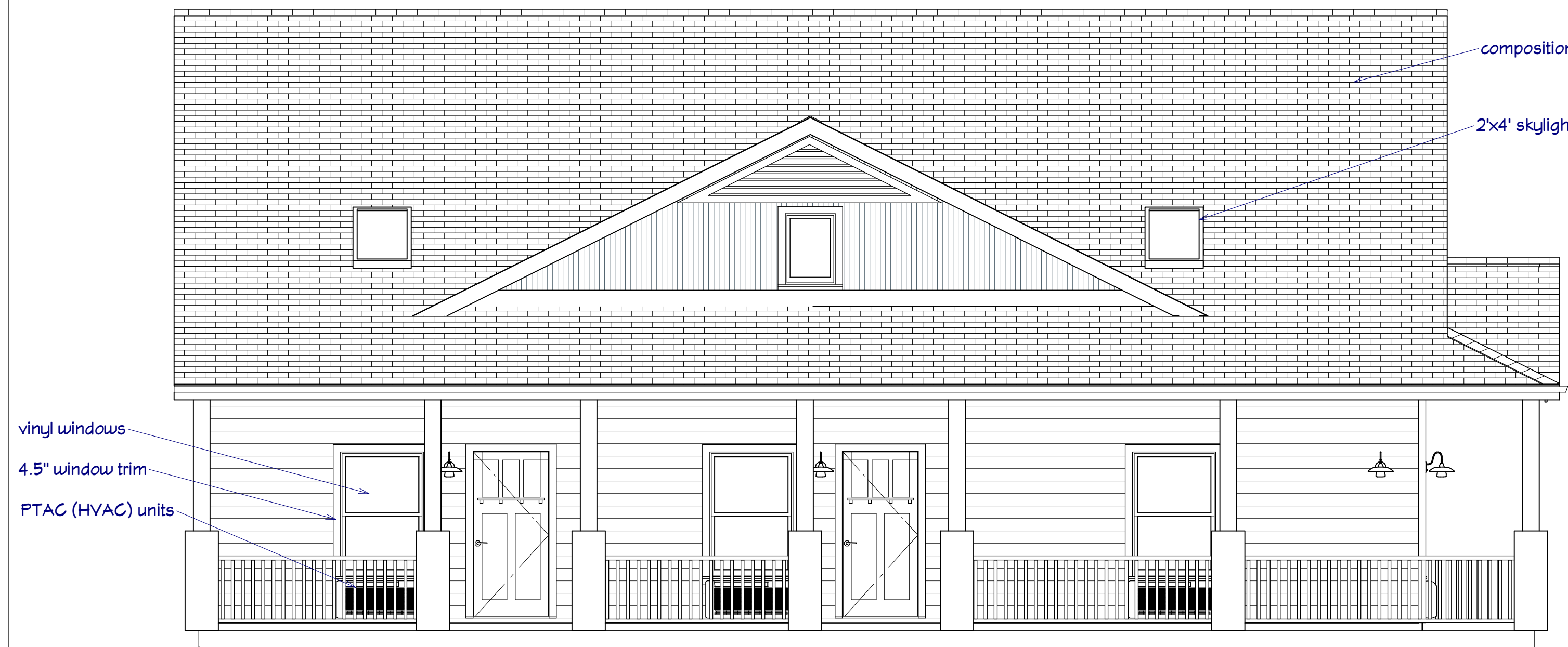
Left Elevation (N. Main St.)
