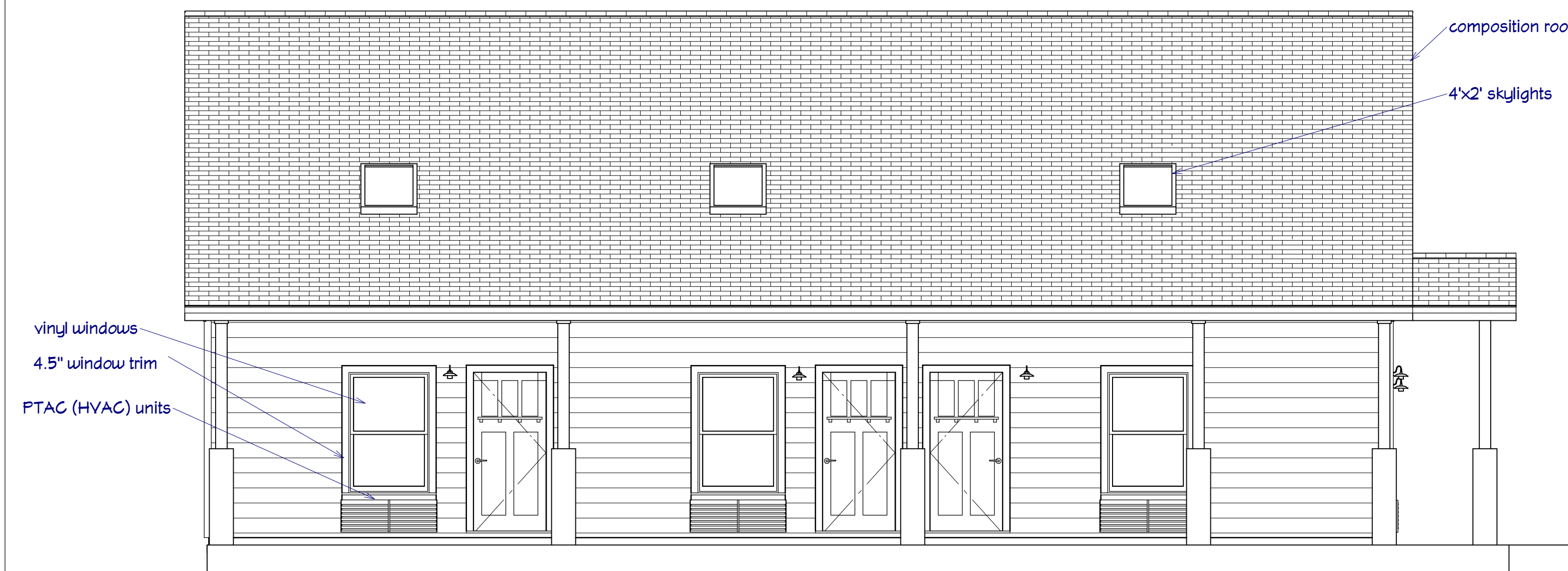
Left Elevation (N. Main St)
